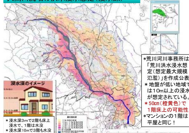
図2 入間川水系(荒川)の洪水浸水想定(浸水深)
