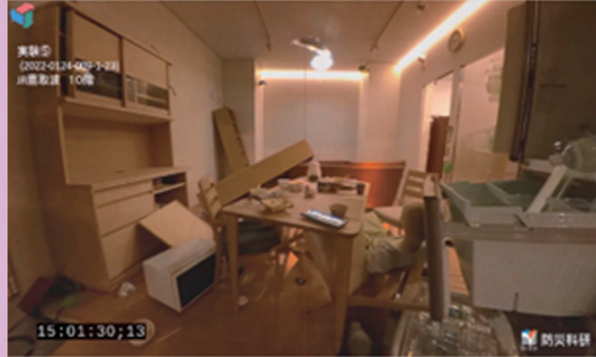
建物が安全でも室内の地震対策を実施しないと危険
