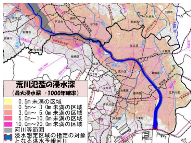
図6 荒川氾濫(1000年確率)の最大浸水深
