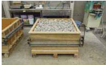
図 4.3 実績率の測定状況（粒径40～80mmの例）
